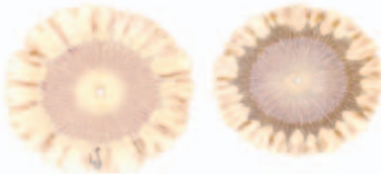
Morphochromatographie de fumier de bovin frais (à gauche) et de compost de fumier de bovin après évolution (à droite)
