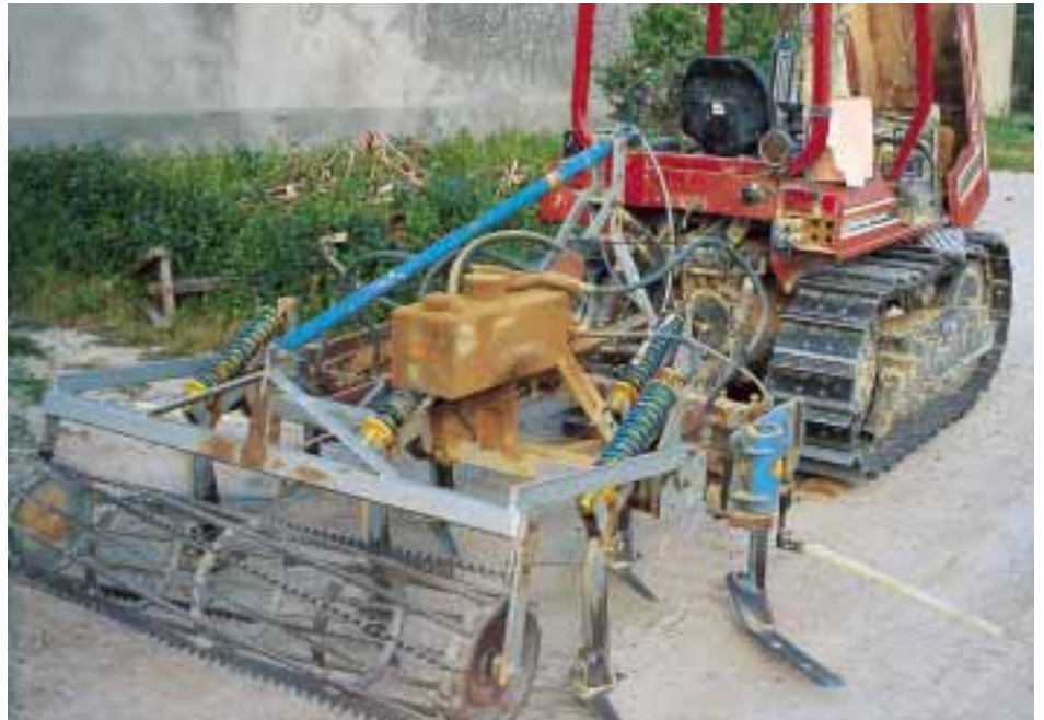
Tracteur chenillard avec cultivateur à dents vibrantes + bineuses interceps
