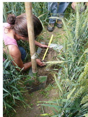
Mise en œuvre du test Beerkan : mesure d'infiltrométrie de l'eau
