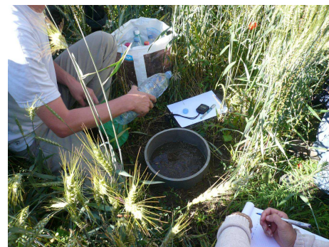
Mise en œuvre du test Beerkan : mesure d'infiltrométrie de l'eau
