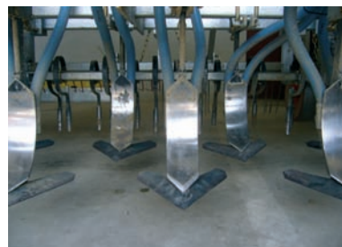
Pattes d'oie avec en bleu les tubes distribuant les graines. Les dents visibles à l'arrière sont destinées à affiner et mélanger la terre après le semis.
