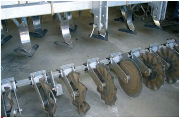
Pattes d'oie avec au premier plan des disques ajoutés si nécessaire pour éviter les bourrages d'herbe.
